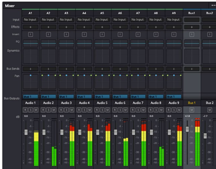
图为调音台，当中的每个通道条分别对应时间线上的相应轨道
