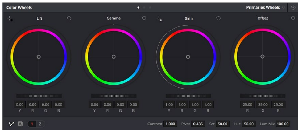
Die Farbräder „Lift“, „Gamma“, „Gain“ und „Offset“ geben Ihnen die volle Kontrolle über die farbliche und tonale Balance Ihrer Clips. Ziehen Sie das Einstellrad unter den Farbrädern hin und her, um jede Farbe eines jeden tonalen Bereichs einheitlich anzupassen
