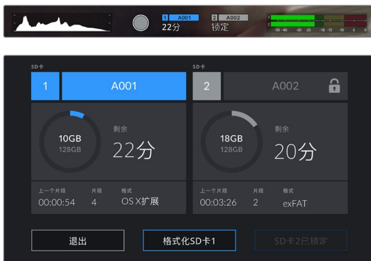
插入了开启写保护锁定的SD存储卡时, URSA Broadcast会给出提示。
