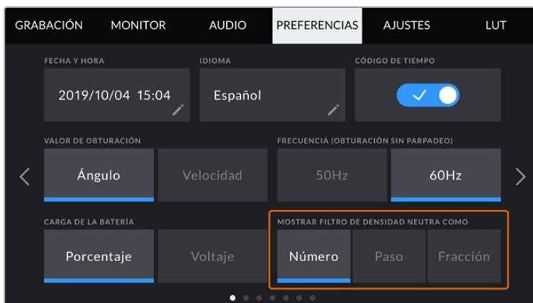
Menú de ajustes en el modelo URSA Broadcast con opción para personalizar la manera en la que se muestra la información sobre los filtros de densidad neutra.
