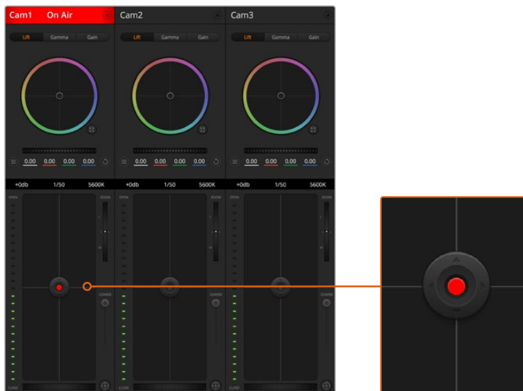
Eine rot leuchtende Blenden-/Schwarzabhebungssteuerung zeigt an, dass die jeweilige Kamera auf Sendung ist
