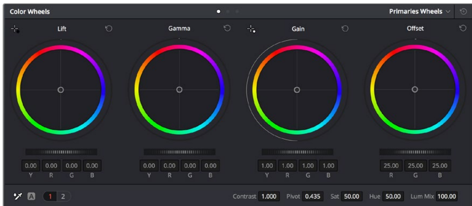
“暗部”、“中灰”、“亮部”、“偏移”色轮用于控制片段的色彩及色调平衡。拖动并来回滚动色轮下方的滚轮可对所有色彩的每种色调区域进行统一的调整。
