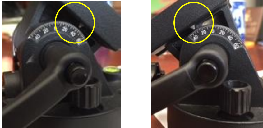
Figure 11. Alt-azi base latitude settings
