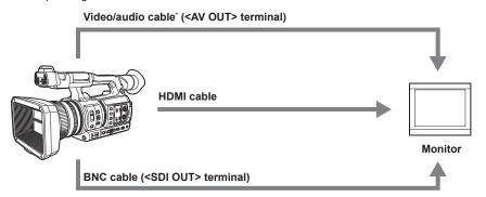
\* Use a commercial video/audio cable (4-pole mini plug). Check the wire specifications of the 4-pole mini plug.
