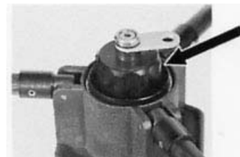
Säulenkappe an Unterseite zur Abdeckung der Gasfeder
